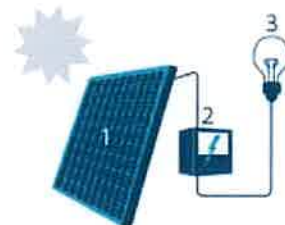
1. Zonnepaneel | 2. Omvormer | 3. Elektrische toestellen
